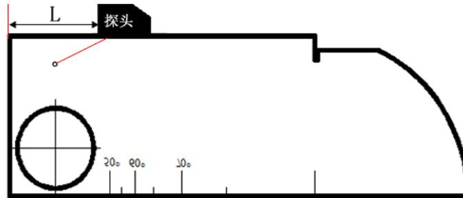
2.按【F3 键】选择“校准 2”按【左键◀】或【右键▶】调整“反射体尺寸”为 1.5,按【下键▼】，选择“D-参考”，按【左键◀】或【右键▶】调整“D-参考”为 15,按【下键▼】，选择“P-参考”，按【左键◀】或【右键▶】调整“P-参考”为测量所得值 L,按【下键▼】，选择“校准测量记录”，再按【确认键】，“校准测量记录”内显示“记录？”
